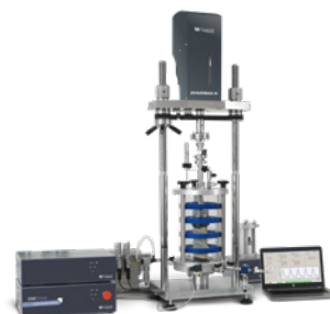
Prove triassiali statiche Prove triassiali cicliche Prove terreni parzialmente saturi Prove di modulo resiliente
