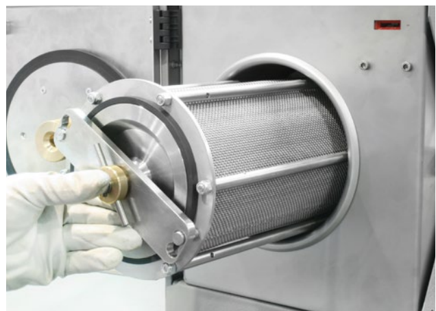
Colocación del tambor de lavado en la máquina
