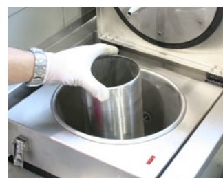
Colocación del vaso de la centrifuga en la unidad
