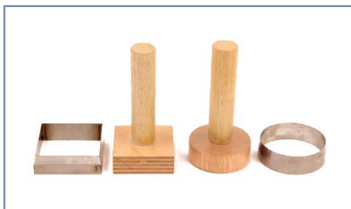
* Cortamuestras y Sufridera de extracción de muestras cuadradas y redondas
