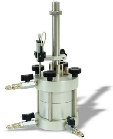
Cella CRS (26-WF0360/AS) con Cella di carico immersa, trasduttore di spostamento e relativo braccetto di supporto
