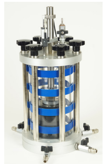
Adattatore CRS (26-WF0360/AD) inserito in cella triassiale 28-WF4070 con cella di carico immersa, trasduttore di spostamento e relativo braccetto di supporto
